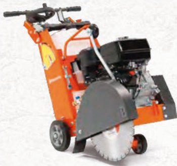
FS 400 | Código 965148217 Motor Honda GX390 Gasolina | 13 hp 99kg Máx. diámetro del disco 18 pulg/ 450 mm Profundidad máx. de corte 162 mm
